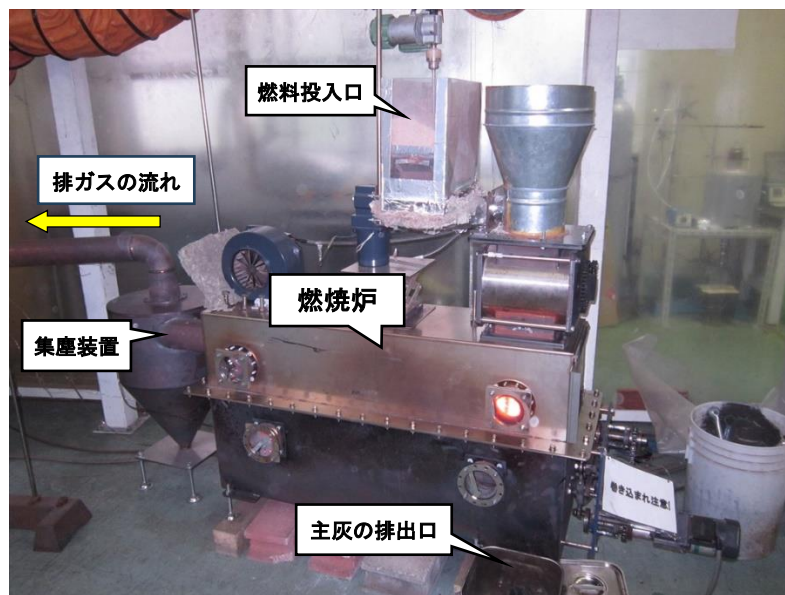
図7 ストーカ式のラボ燃烧炉
